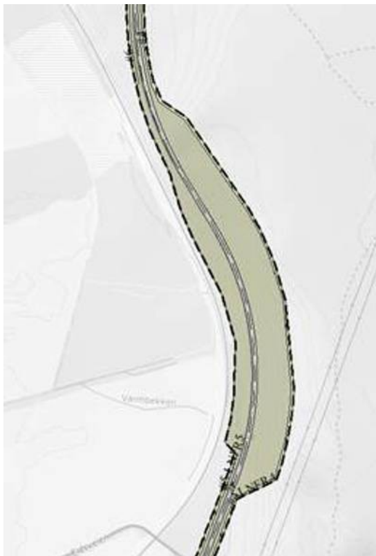
Fig. 5. Ved Nessegga vil veilinja bli endret, da egga overfor veien skal tas ned, og det skal fylles opp på utsiden av egga.
