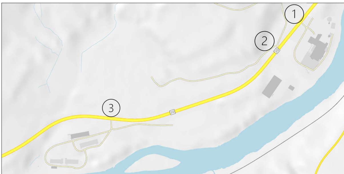
Fig. 2.7.1: Fylkesvei 30 går gjennom planområdet. På vegkart.no er det registrert tre avkjørsler innenfor planområdet. Disse er nummerert 1, 2 og 3, og foto som viser dagens situasjon er vist i de påfølgende figurene (Kilde: fra vegkart.no).
