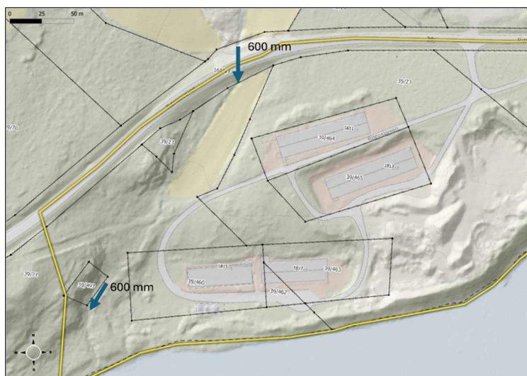
Figur 2.8.3: Oversikt over plassering og dimensjonering av kulverter langs Kåsbekken. Kulvertene det pekes på er ikke dimensjonert for å ta unna vann tilsvarende 200- årsflom + 20%, og kan skape utfordringer for planområdet (Skrid Aktsomhet AS, 17.12.2024).
