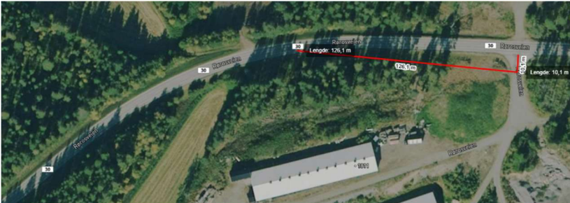
Figur 5.5.8: Ortofoto fra avkjøringen med mal for avkjørsler som stadig trafikkeres av lastebiler i gult. Både bredde på vei og svingradier i avkjøringen er tilfredsstillende.
